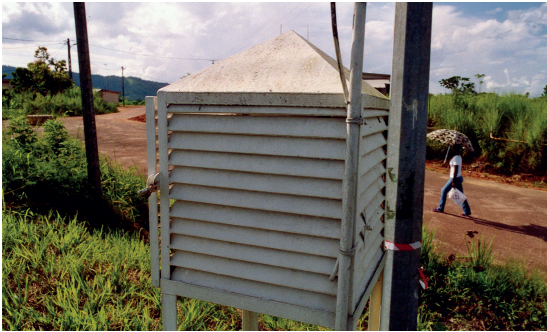
Station zur Radioaktivitätsmessung im ehemaligen Minenquartier von Mounana. Die Resultate der Messungen sind Verschluss-sache.
